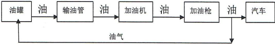
图 3-1 加油工艺流程图
